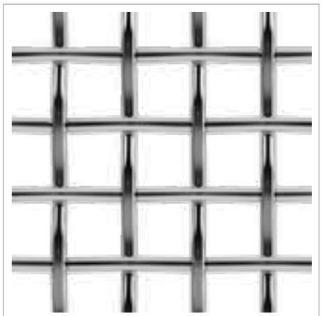
Le reti tessute vengono realizzate mediante tessitura in trama ed ordito di fili metallici. Si utilizzano fili continui non preventivamente ondulati o sagomati.
